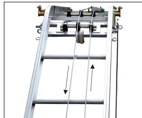
37. att. Troses vadīšana gar locīšanas mezglu
